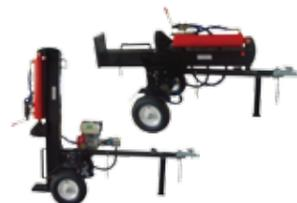
縦でも横でも薪を割ることができます。大きな丸太を割る場合は、マルチを薪割り機に持ち上げる作業が重労働になり、腰を痛める原因となります。そんなときは、縦型でお使い頂くと楽に丸太をセットできます。
