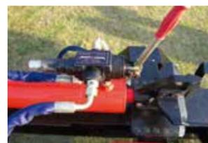
ワンハンドルで薪を割ることができます。大型モデルの薪割り機によくある2ハンドルの仕様と比べて作業効率がアップします。
