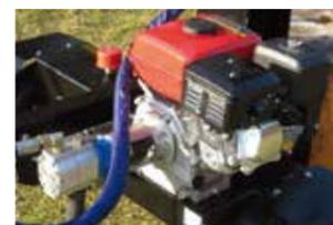
特別なメンテナンスは、全く必要ないため、機械に詳しくな方でもご利用いただけます。1年に1度、エンジンオイルと油圧オイルの交換をするだけで、未永くご利用いただけます。
