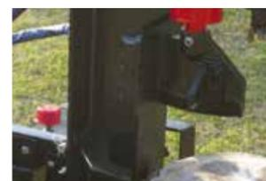
4分割カッターを使うことで、一度に4分割に割ることができます。そのため、薪割りの作業効率が大幅にアップします。取り付けは、薪割機のカッター部分にセットするだけです。使いたい時にいつでも使うことができます。
